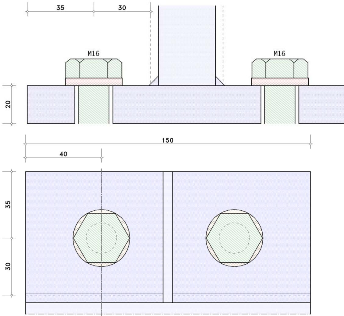
T-Stummelflansch mit Dicke  $t_f = 20.0$  mm, Länge  $l_f = 150.0$  mm, Stahlgüte S235
