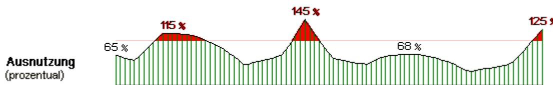
Sind alle Ausnutzungsgrade  $\leq 100\%$ , kann der Nachweis als erbracht und der Träger als tragfähig angesehen werden. Andernfalls muss über eine Änderung der Materialgüte bzw. des gewählten Querschnitts/Profils nachgedacht werden.
