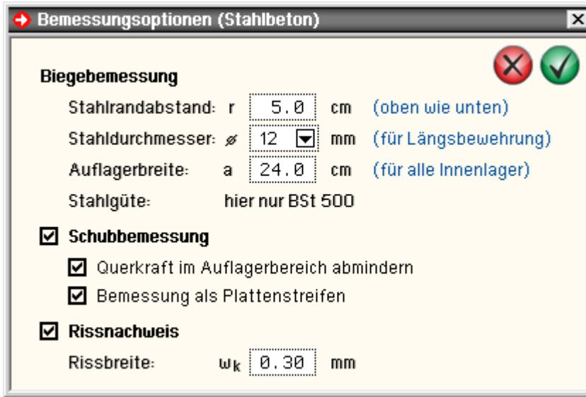
Zunächst ist der Stahlrandabstand als Abstand des Schwerpunkts der Stahleinlagen für die Längsbewehrung zum Querschnittsrand festzulegen.
