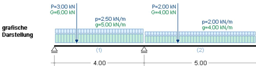
Der o.a. Beispielgrafik kann entnommen werden, dass ein rechts eingespannter Zweifeldträger vorliegt, der feldweise mit unterschiedlichen Gleichstrecken- und zwei Einzellasten belastet ist.
