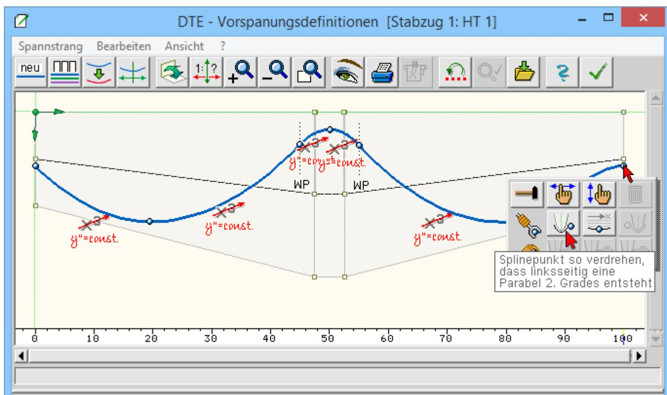
Bis auf eine Kleinigkeit ist der SpStrV damit komplett: Formal muss der letzte Meter vor einem Spannanker aus einer Geraden bestehen. Hierfür sind wiederum Zwischenpunkte in den letzten Abschnitten zu erzeugen, diese an den richtigen Ort zu rücken und eine Gerade zu erzwingen.
