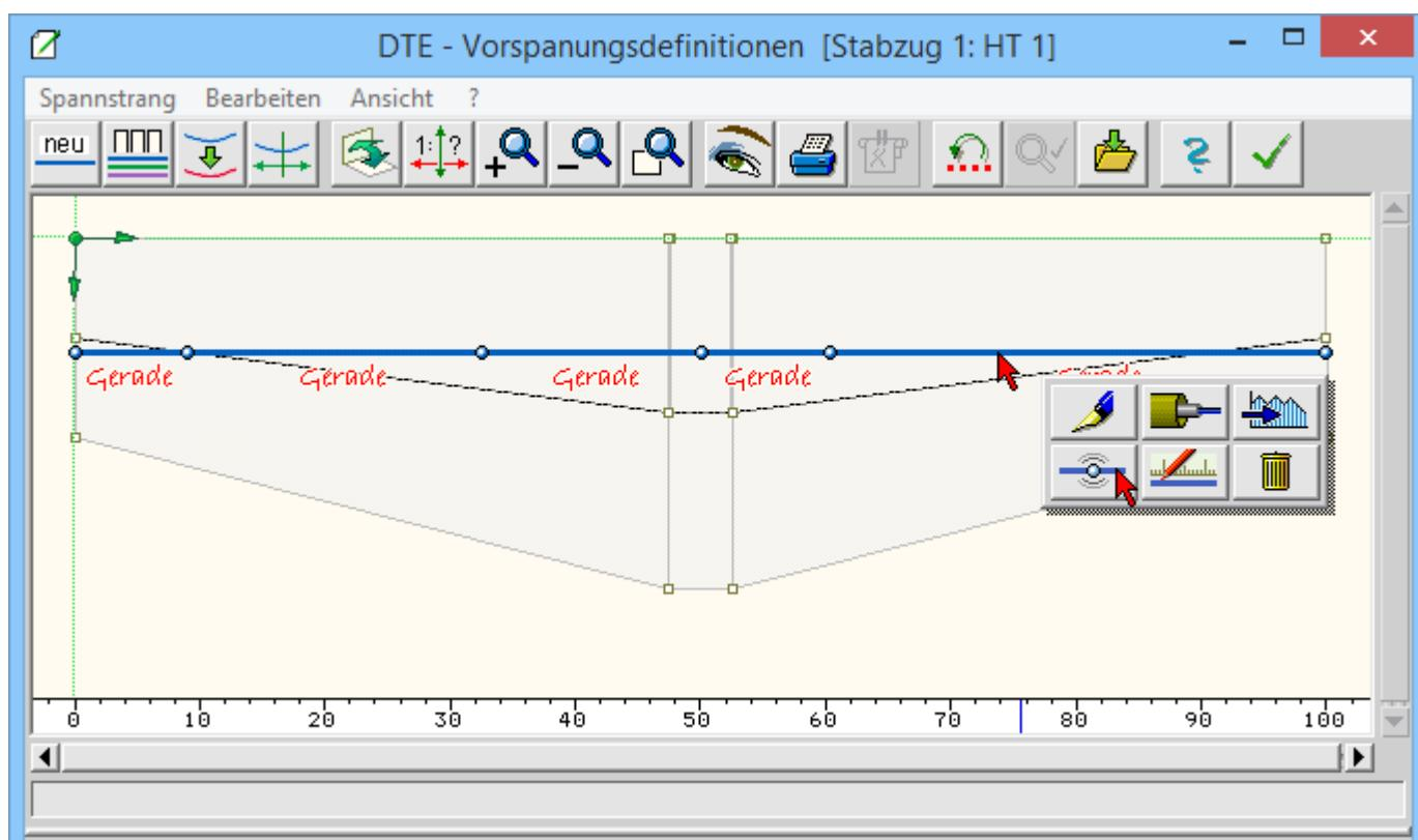
Nun sind die willkürlich erzeugten Zwischenpunkte in die jeweilige korrekte Position zu rücken und der quadratische Parabelverlauf (mit gleichmäßiger Verteilung der Umlenkräfte) zu erzwingen.
