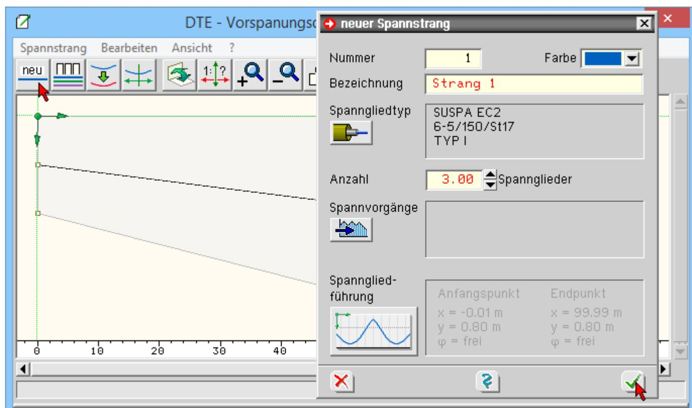
Durch Anklicken der markierten Buttons und Eintrag der Werte entsteht zunächst ein horizontaler Spannstrangverlauf (SpStrV).
