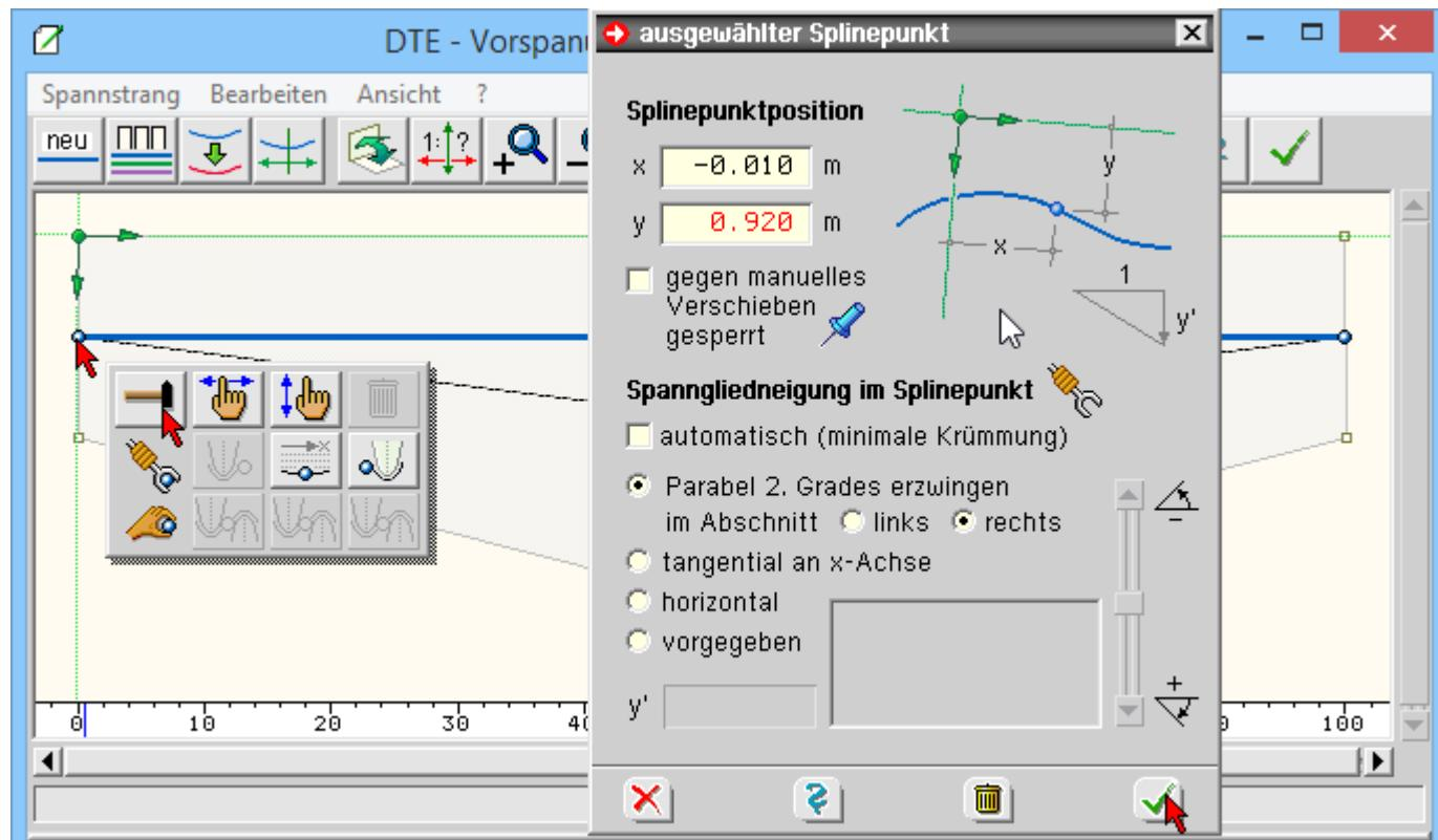
Auf dem weiterhin geraden SpStrV werden fünf Zwischenknoten für Tief- und Wendepunkte benötigt, die durch mehrmalige Ausführung der unten gezeigten Aktion erzeugt werden.
