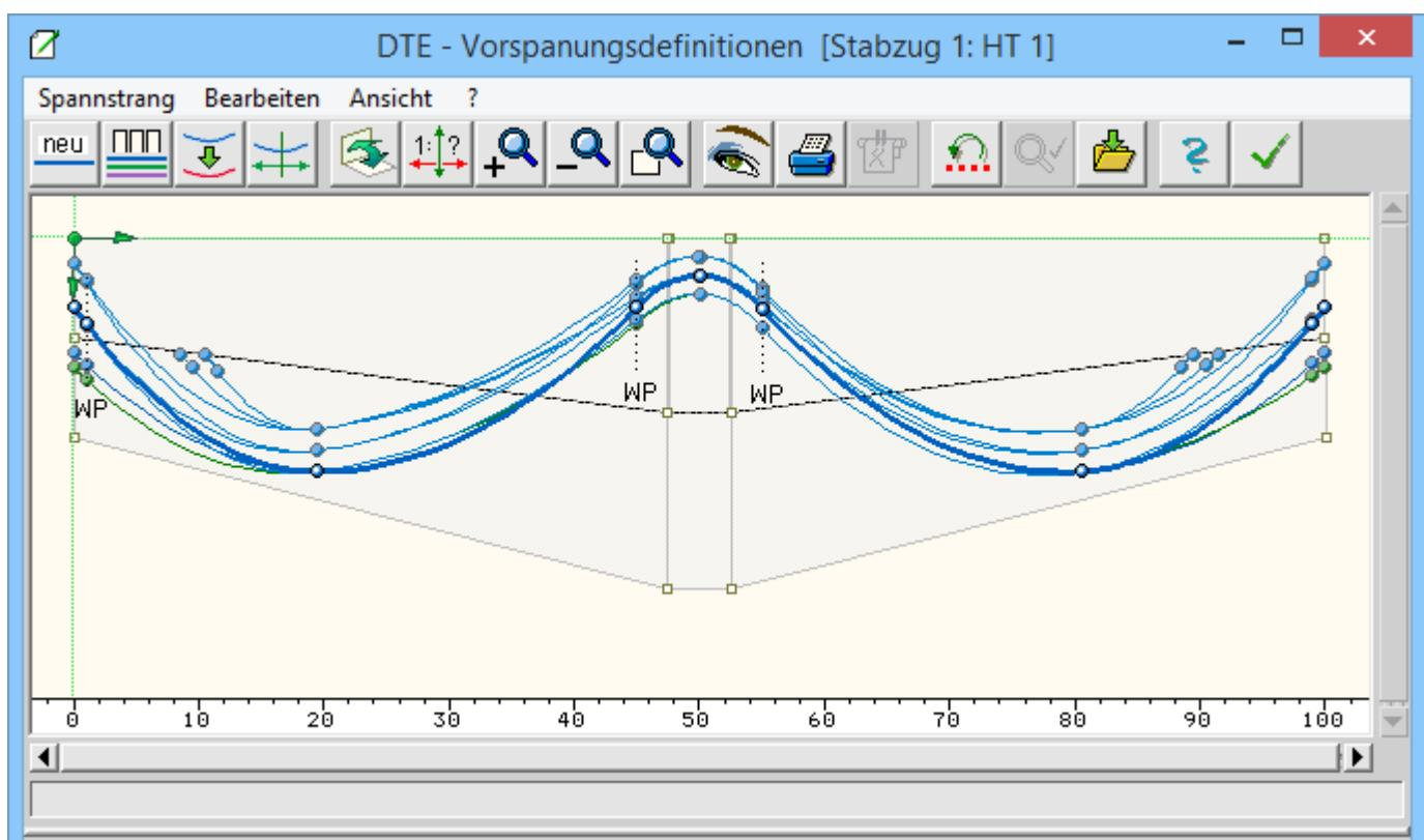
Das Ergebnis entspricht der eingangs gezeigten Spannstranggeometrie, wobei hier - abgesehen von den gewählten Farben - zusätzliche Punkte entspr. dem geraden Endabschnitt enthalten sind.
