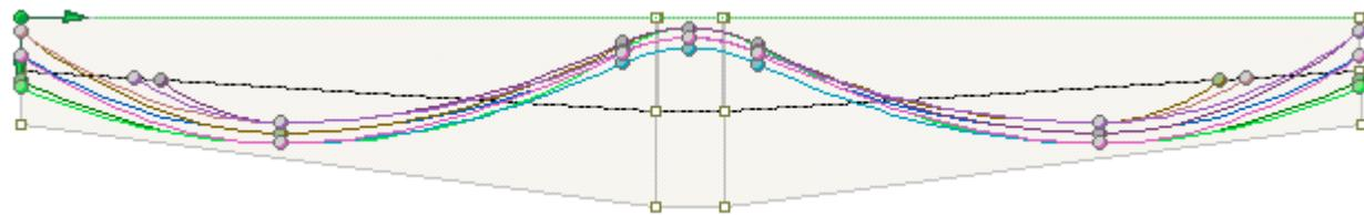
Das Tragwerk besteht aus zwei gevouteten Endfeldern und einem kurzen Mittelfeld mit konstantem Querschnitt. Aufgrund der in Normen und Zulassungen festgelegten Anker- und Hüllrohrabstände zu Rändern und untereinander ergeben sich die in den folgenden Bildern dargestellten Ankerlagen und Hüllrohrgeometrien in den Feldern. Hierbei wurde es erforderlich jeweils vier Spannglieder innerhalb des Baukörpers zu verankern.
