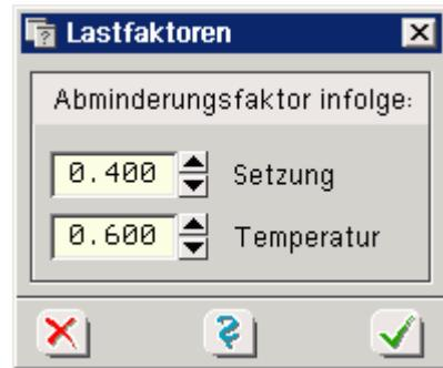
Die Sicherheitsbeiwerte gemäß DIN Fachbericht 101/102 sind über den Brückentyp standardmäßig voreingestellt.
