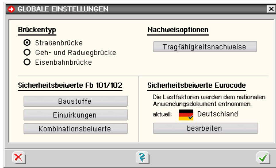
Zunächst ist der Brückentyp festzulegen, was i.W. Einfluss auf die Teilsicherheitsbeiwerte ( $\gamma$ -Werte) und Kombinationsbeiwerte ( $\psi$ -Werte) nach DIN Fachbericht 101, Anhang C und D, bzw. Eurocode, die vom Programm automatisch gesetzt werden (Standardwerte).
