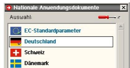
NAe enthalten die Parameter der nationalen Anhänge der verschiedenen Eurocodes (EC 0, EC 1, EC 2 ...) und ermöglichen den **pcae**-Programmen das Führen normengerechter Nachweise, obwohl sie von Land zu Land unterschiedlich gehandhabt werden.
