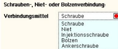
Ankerschrauben sind bei Wahl des EC 3-1-8:2010 nicht verfügbar.
