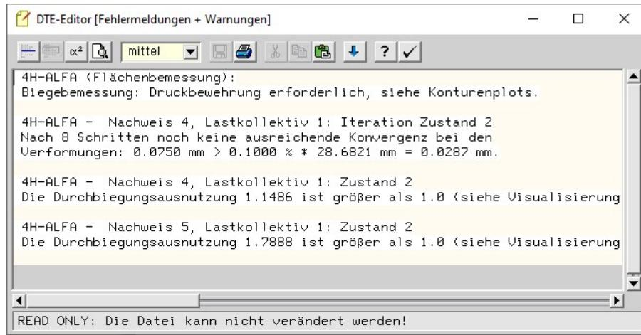
In den positionsbezogenen Bemessungsoptionen kann eine zulässige Durchbiegung  $w_{req}$  vorgegeben werden, aus der eine Durchbiegungsausnutzung  $U_w = \max w / w_{req}$  berechnet wird. Falls diese Ausnutzung den vorgegebenen Wert überschreitet, wird die Iteration ebenfalls beendet.
